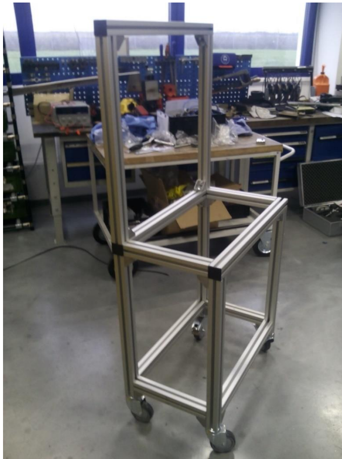
Fig.4.25 Structură suport a standului, construită cu: profil metalic BOSCH 45x45/ capace profile 45x45 D8 / roți cu autoblocare (125mm), îmbinarea realizată cu unghiuri de îmbinare 45x45
