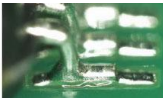
Figura 18.2. Pasta conductoare solidificata
