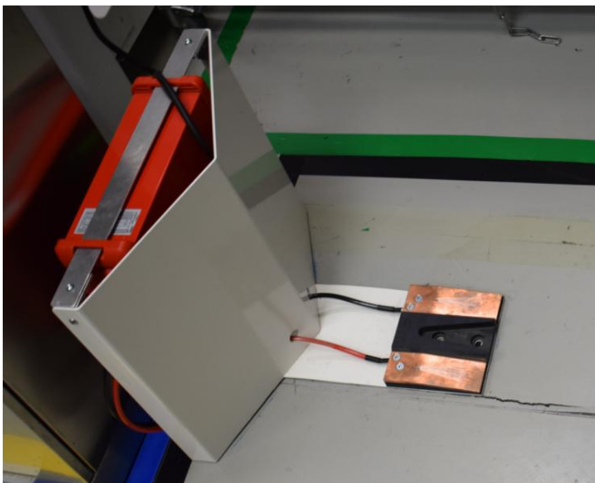
Figura 60. Statia de incarcare a robotului
