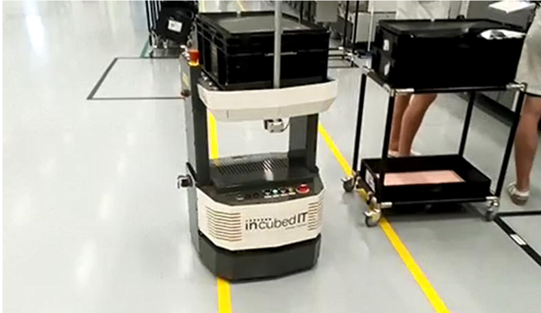
Figura 64. Robotul efectuand o ocolire a unui carucior aflat pe traiectoria sa de deplasare (traiectorie paralela cu liniile galbene din imagine)
