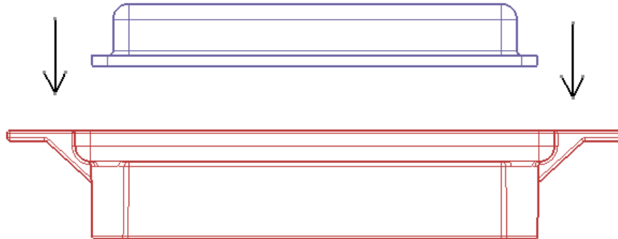
Figura 6.8 Mișcarea pe direcția Z a capacului, în momentul asamblării
