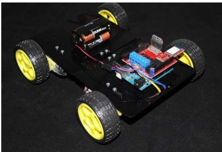
Fig. 3.1.2. Robot mobil cu Arduino
