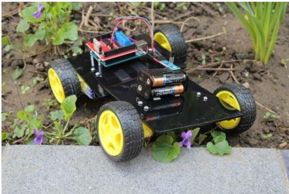
Fig. 3.2.1. Robot mobil, comandat prin telecomandă IR
