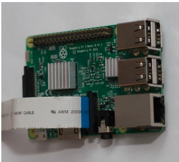
Fig 3.7 Conectarea cablului la interfața CSI
