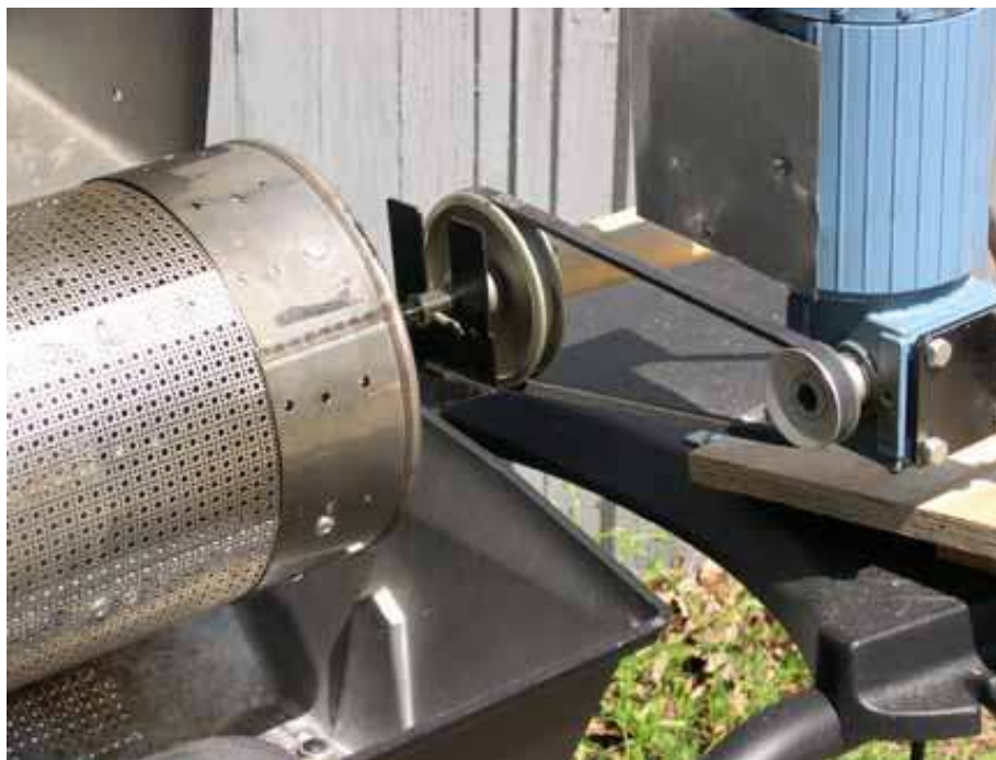
Transmisie prin curea utilizată la angrenarea unui sortător agricol de către un motor electric.
