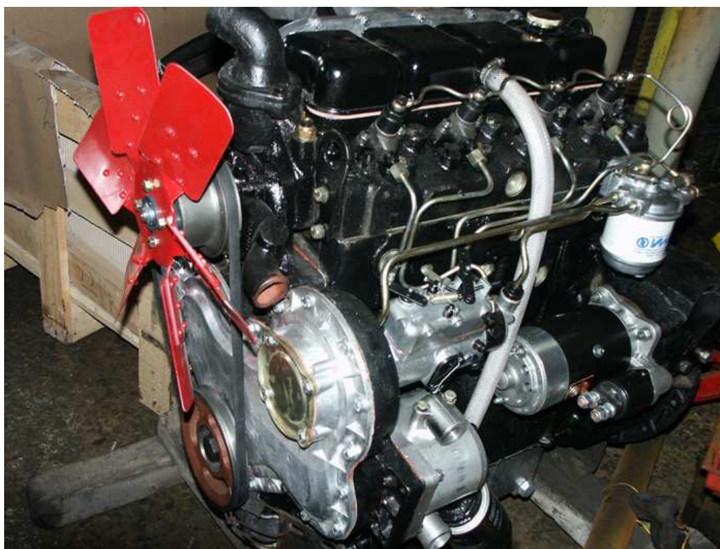
Transmisie prin curea utilizată la angrenarea pompei de apă de către arborele cotit.
